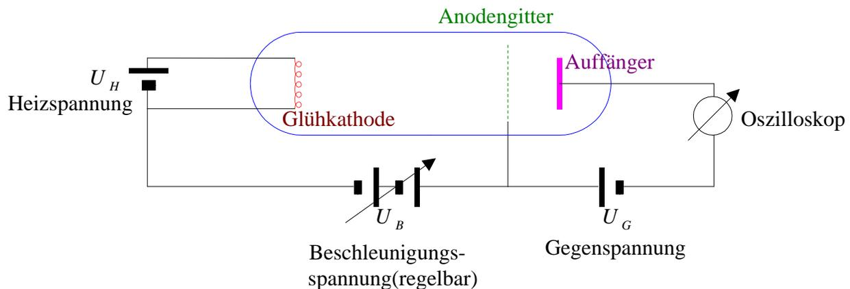
Die Quecksilberröhre muss zusätzlich geheizt werden, damit sich ein ausreichend hoher Sättigungsdampfdruck einstellt. Die Temperaturmessung war allerdings ein Problem, denn während der Versuchsdurchführung schwankte die Temperatur stark, weil das Thermostat der Röhrenheizung nur eine einfache Regelung per Bimetallstreifen beherrscht.
