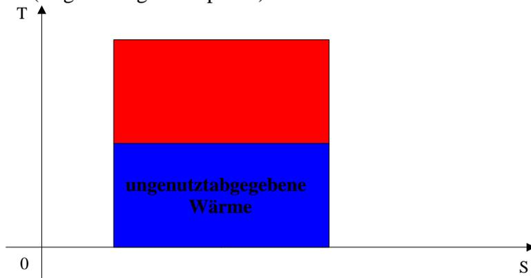
Reversibilität bedeutet nicht, dass keine Energie ungenutzt umgesetzt wird (siehe T-S-Diagramm)!
